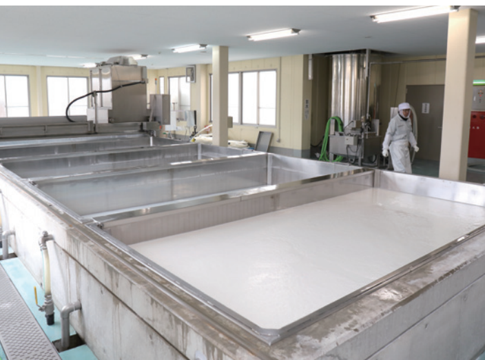
大きな水槽が何槽も並ぶ工場では、葛粉を精製するために大きな攪拌機が稼働していました。ひんやりとした工場内は雑菌などが入らないように衛生管理が徹底されています
