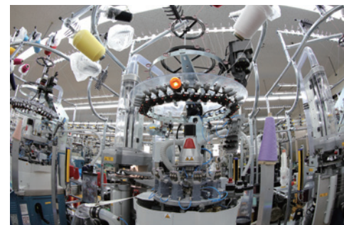
さまざまな色の糸が備え付けられた靴下編機。人の手で調整しながら編み上げられています
